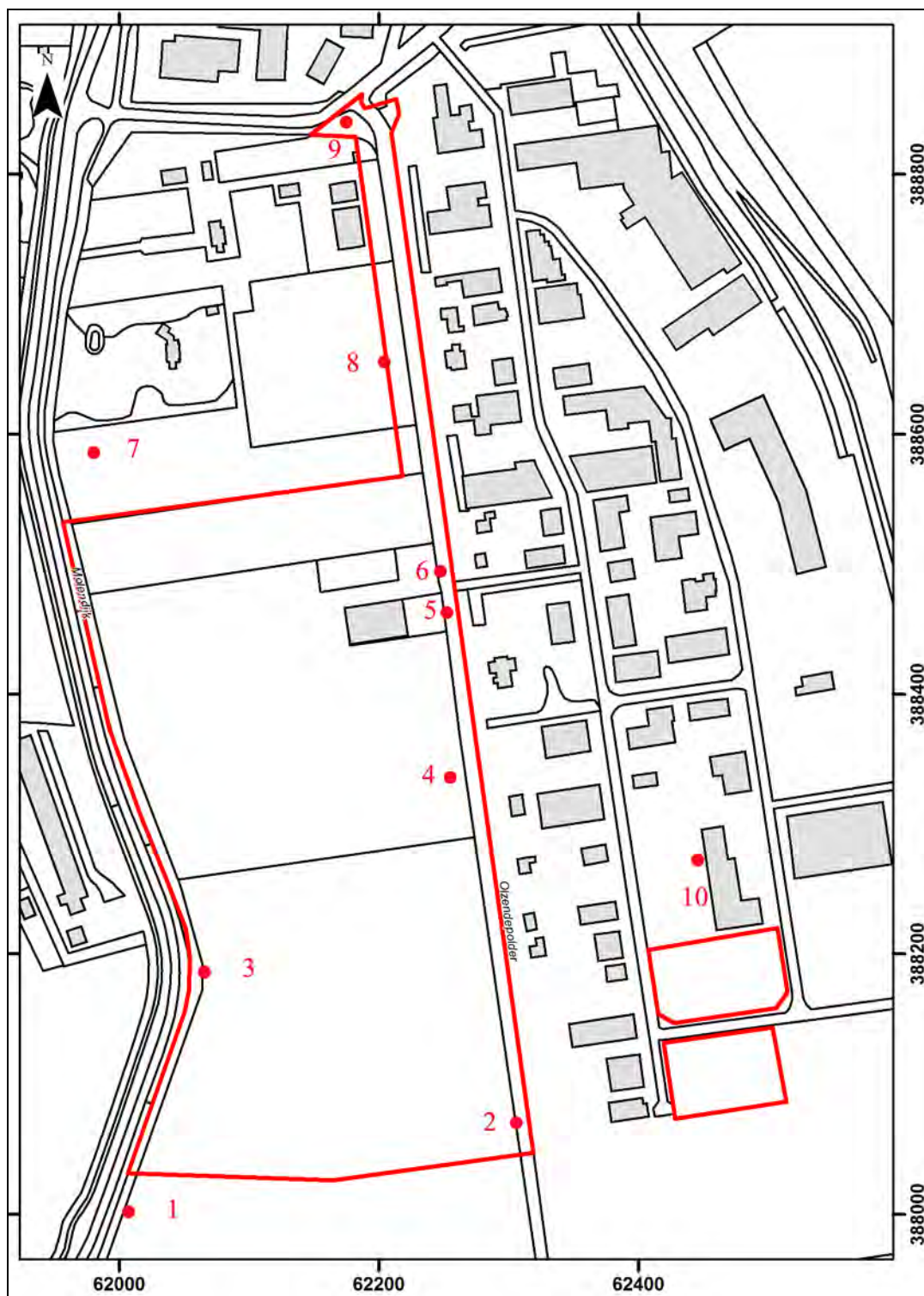
Afbeelding 8. De locatie van de in het DINO-loket gearcheeërde boringen (rood gemarkeerd en genummerd), ter plaatse - en in de omgeving - van het onderzoeksgebied (rood omkaderd). Bron GBKN: Topografische Dienst, Emmen. Schaal 1: 5.000.
