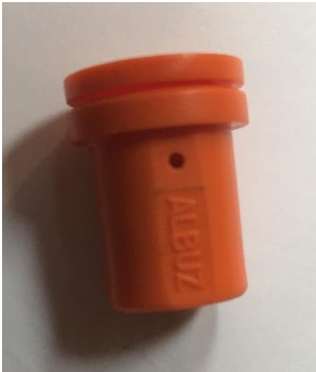
Afb.: Spuitdoppen ALBUZ TVI 80 01, 90% DRT, toegepast door W.A. Bruijnzeel
