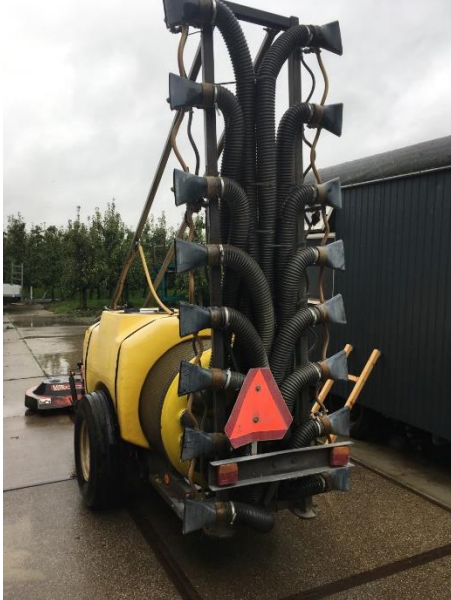
Afb.: boomgaardspuit (dwarsstroomspuit) fruitteler W. Bruijnzeel
