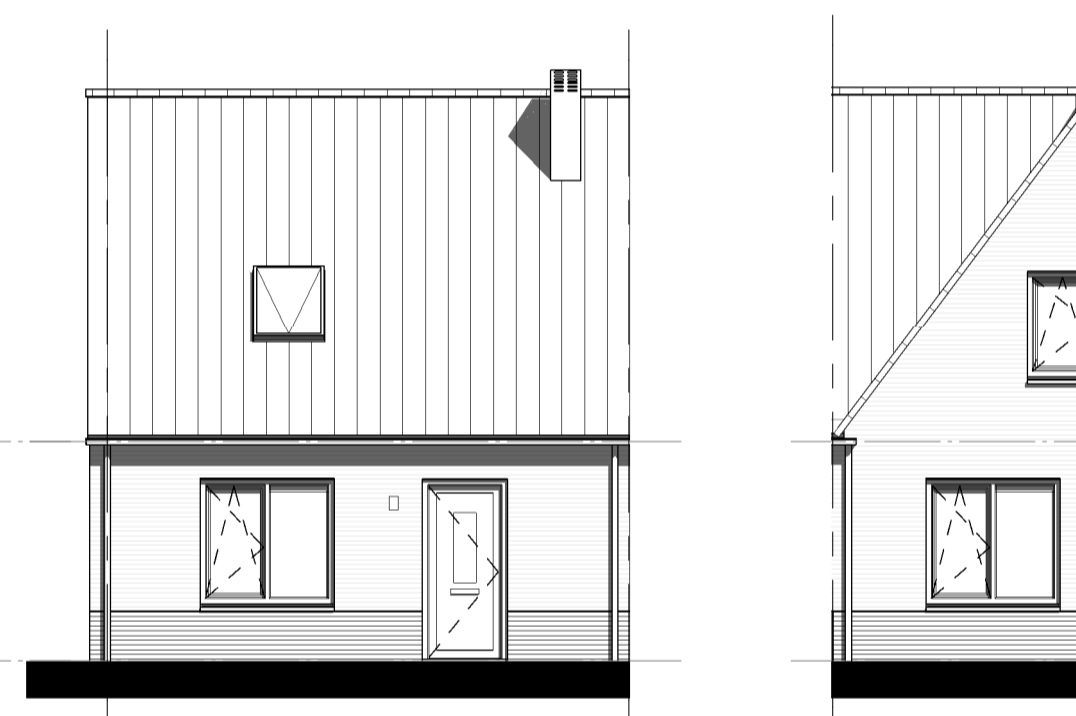
Voorgevel langskap hoekwoning 1 : 100
