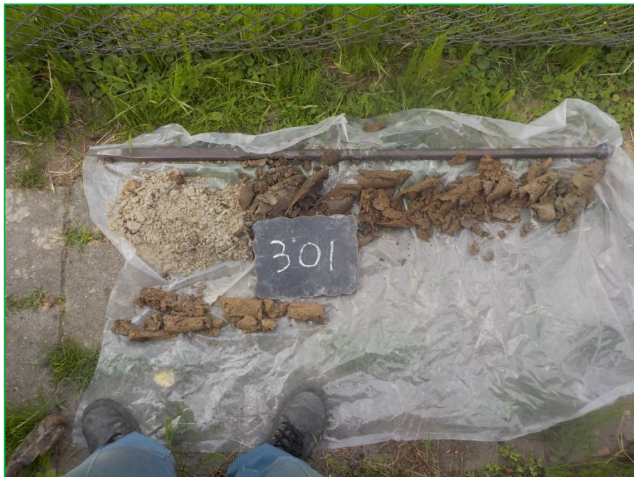
Foto 5. Impressie uitkomend materiaal boring 301.
