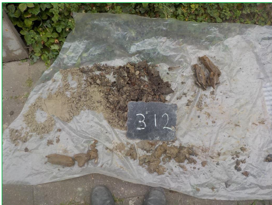
Foto 16. Impressie uitkomend materiaal boring 312.
