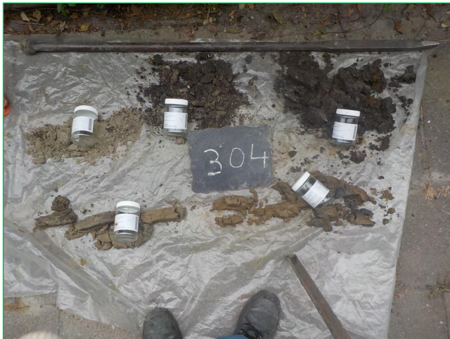
Foto 9. Impressie uitkomend materiaal boring 304
