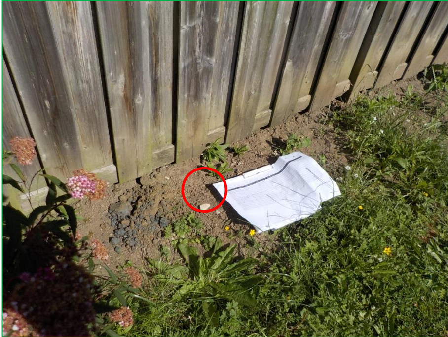
Foto 7. Lichtgekleurd asbesthoudend materiaal op maaiveld links van A3-papier (rood omcirkeld).
