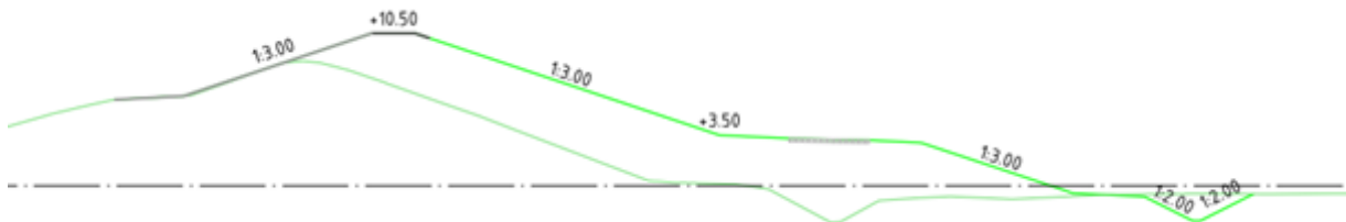
Afbeelding 2.24 Dwarsprofiel - Dorpsrand Zeedijk - Sportvelden (dijkpaal 268 - dijkpaal 271)
