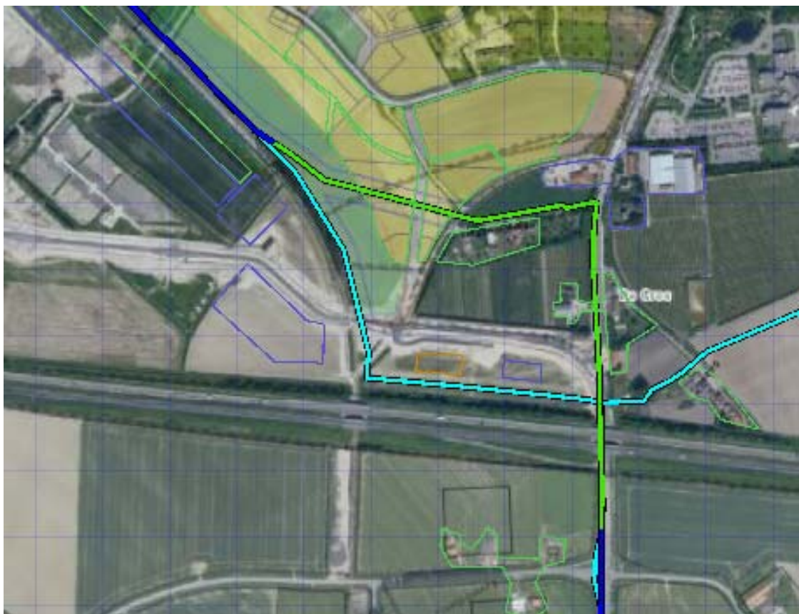
Figuur 4.2 Kilometer leiding behorende bij de maximale overschrijding van de FN-curve voor Z-567-05 van N.V. Nederlandse Gasunie
