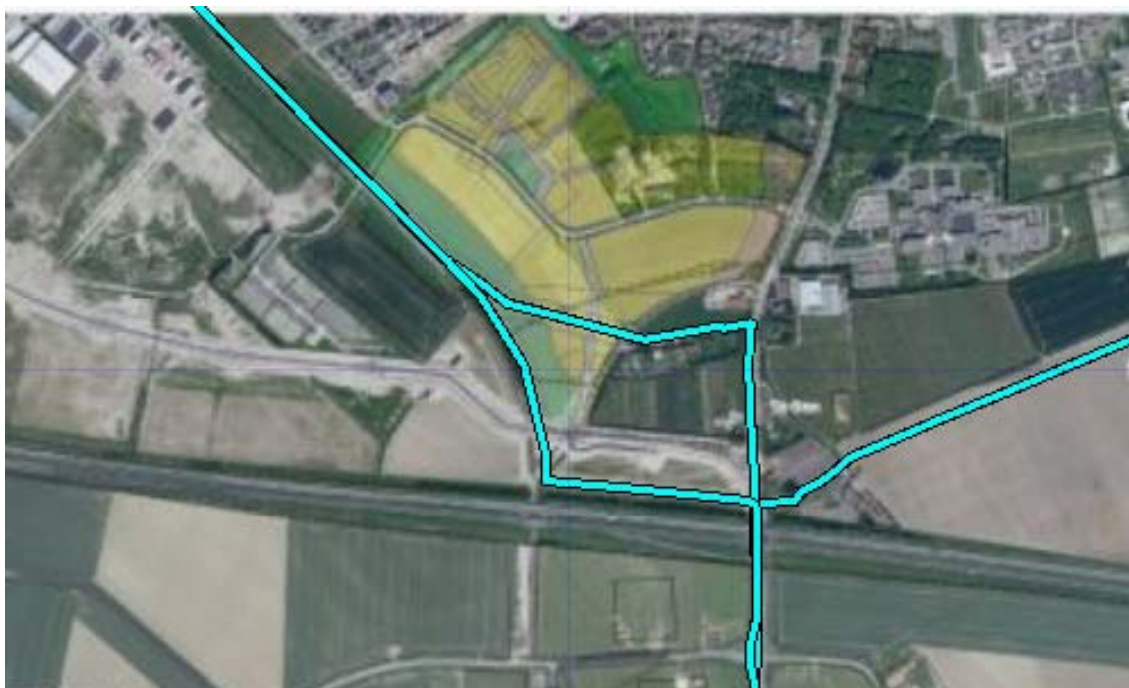
Figuur 2.2 Buisleidingen aanwezig in de omgeving van het interessegebied
