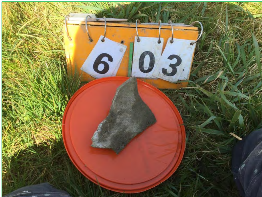
Foto 7. Asbesthoudend materiaal proefgat 603
