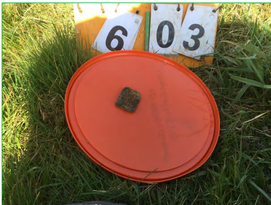
Foto 8. Asbesthoudend materiaal proefgat 603
