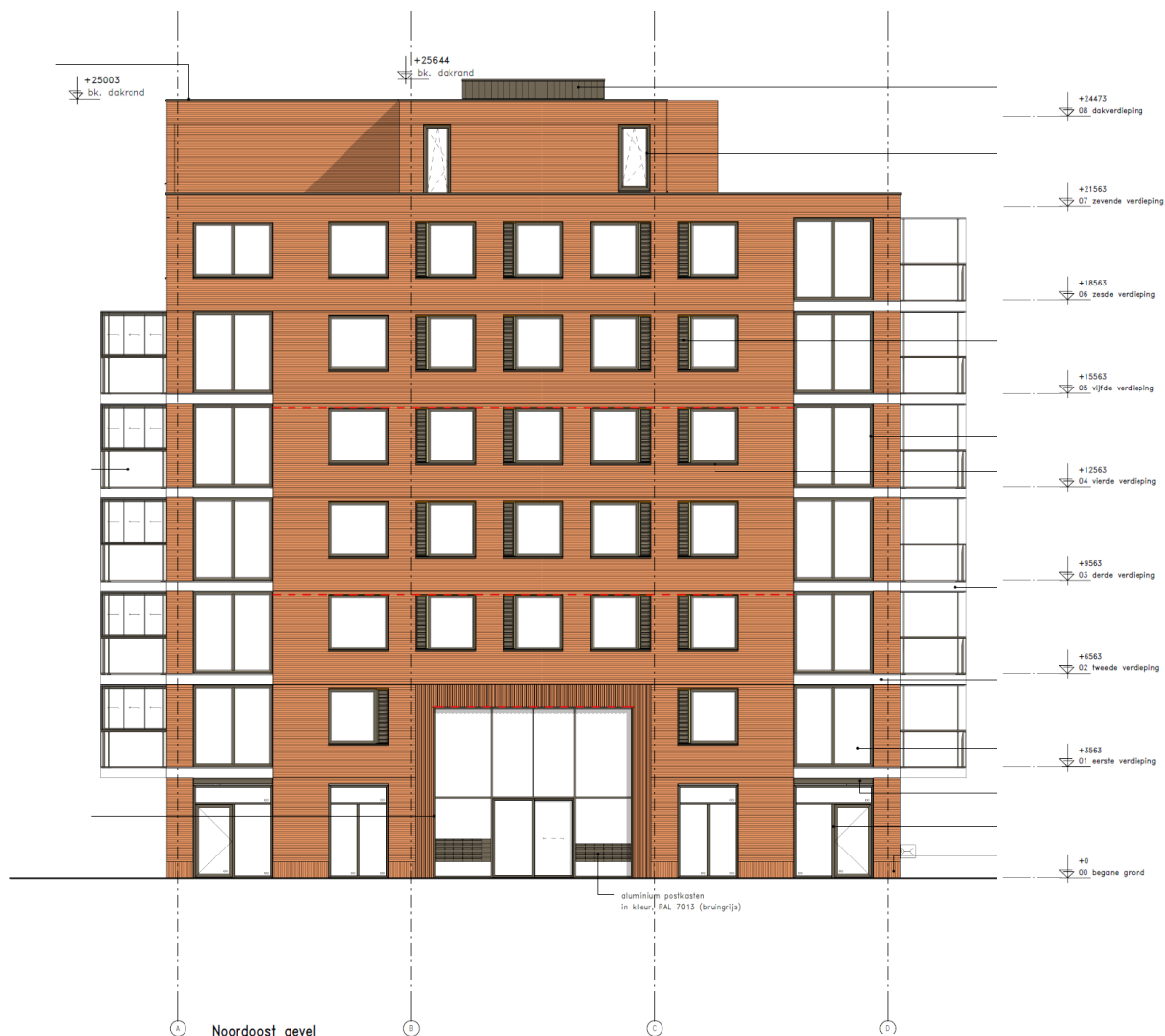
Afbeelding 2.6: aanzicht met maatvoering van de noordoostgevel, op basis van het definitief ontwerp (januari 2020)
