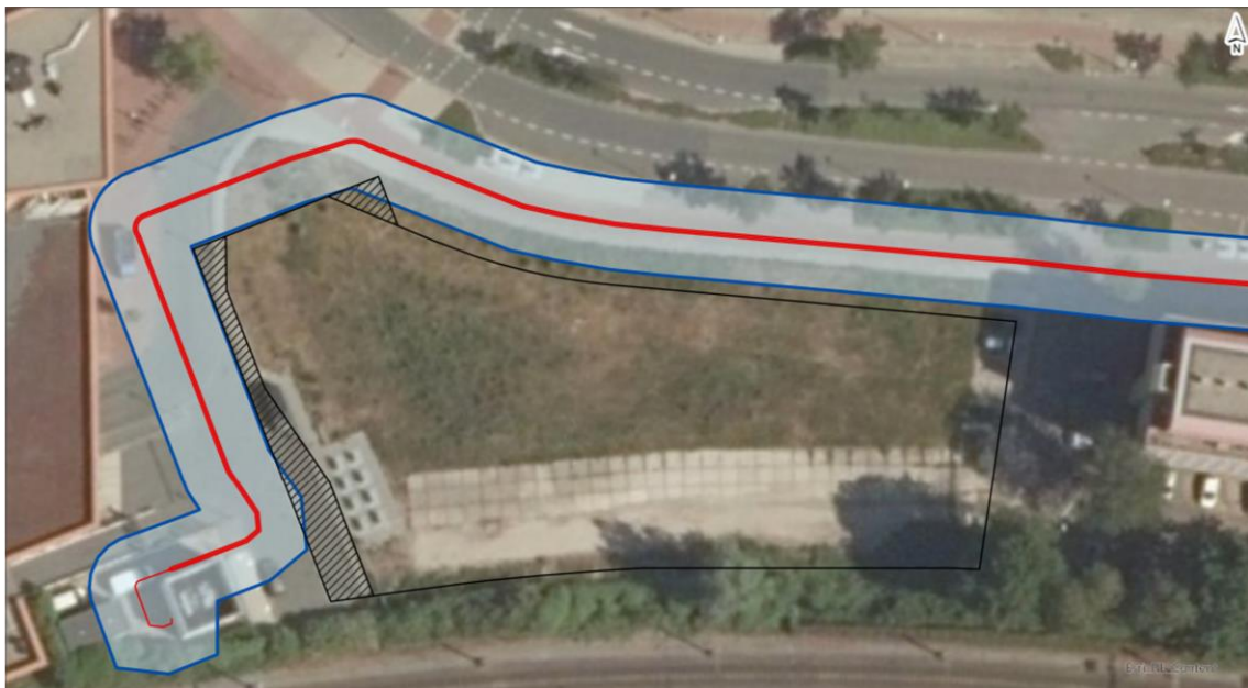
Afbeelding 3.2 Magneetveldzone van 0,4 microtesla nabij Cadenza II. Hoogspanningsverbinding (rood), magneetveldzone boven 0,4 microtesla (blauw) en het doelgebied (zwart). Het doelgebied (zwart) is gesplitst in een gearceerd deel en een niet gearceerd deel. Het zwart gearceerde deel is de zone waar overbouwning mogelijk is en het niet gearceerde deel geeft de maximale bebouwingsgrens aan
