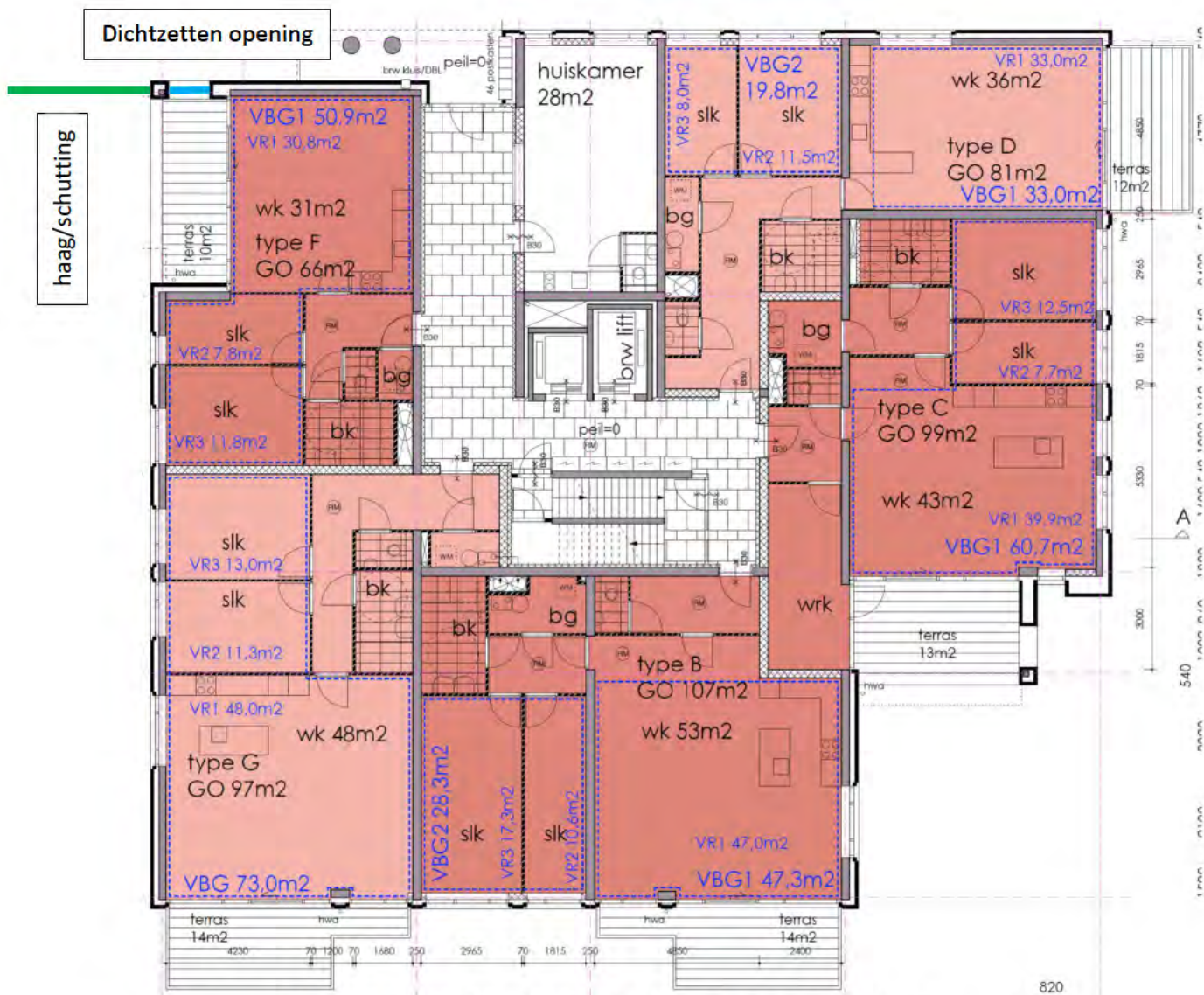
Figuur 3.4.5: Aanbrengen haag/schutting en dichtzetten gevelopening loggia
