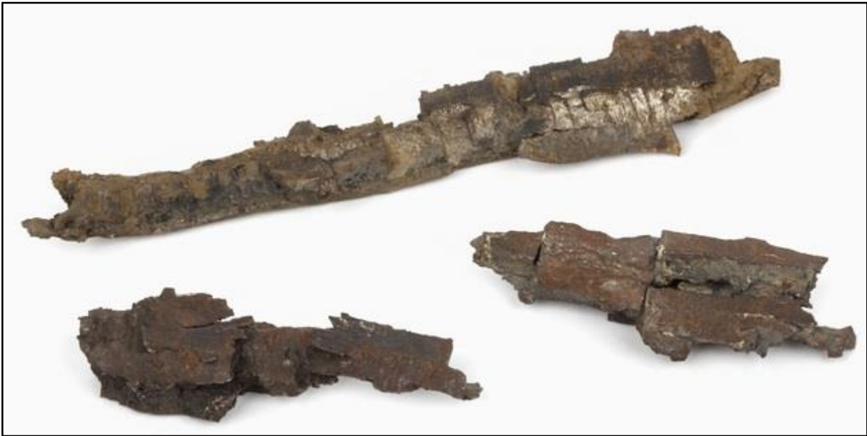
Figuur 14. Scherven afkomstig van een projectiel dat was gevuld met springstof, na detonatie.
