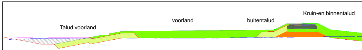
Figuur 4.5 Principeprofiel kleibekleding kaden Middengebied
