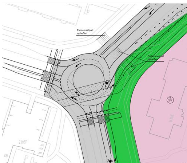
Figuur 4.1: Ruimtebeslag turborotonde Bredewater - Meerzichtlaan
