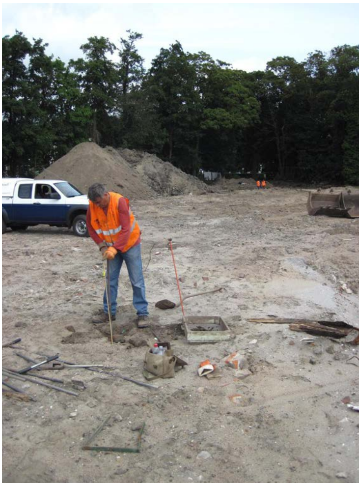
Figuur 21: Woerden, Defensie-eiland. Foto genomen tijdens het booronderzoek. Om door de bovenste puinlaag te komen, werd gebruik gemaakt van boor, puinboor, breekijzer, schep en prikstok.
