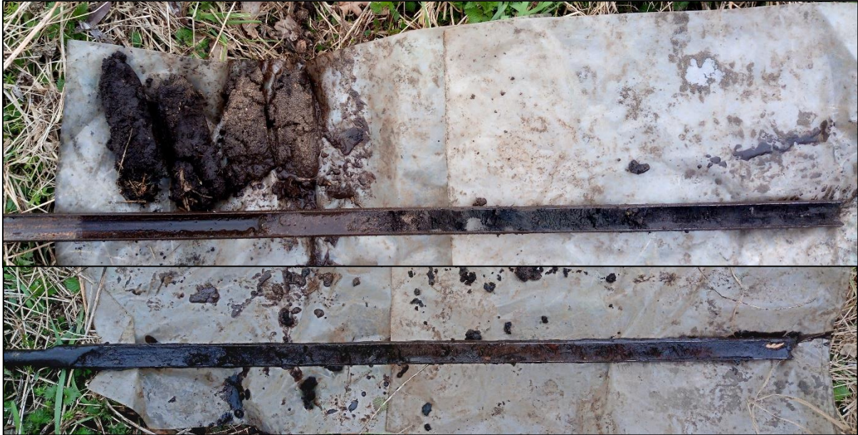
Boring 1. Boven: 0-100 cm -Mv. Onder: 100-200 cm -Mv.
