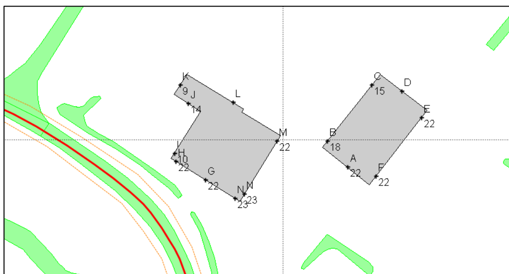
Figuur 4 Hoogst berekende geluidbelasting vanwege de Middenweg inclusief aftrek conform artikel 110g Wgh
