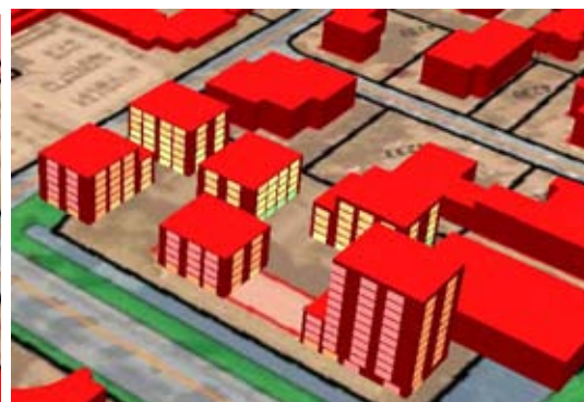
Oostgevels: <47-64 dB L cum
