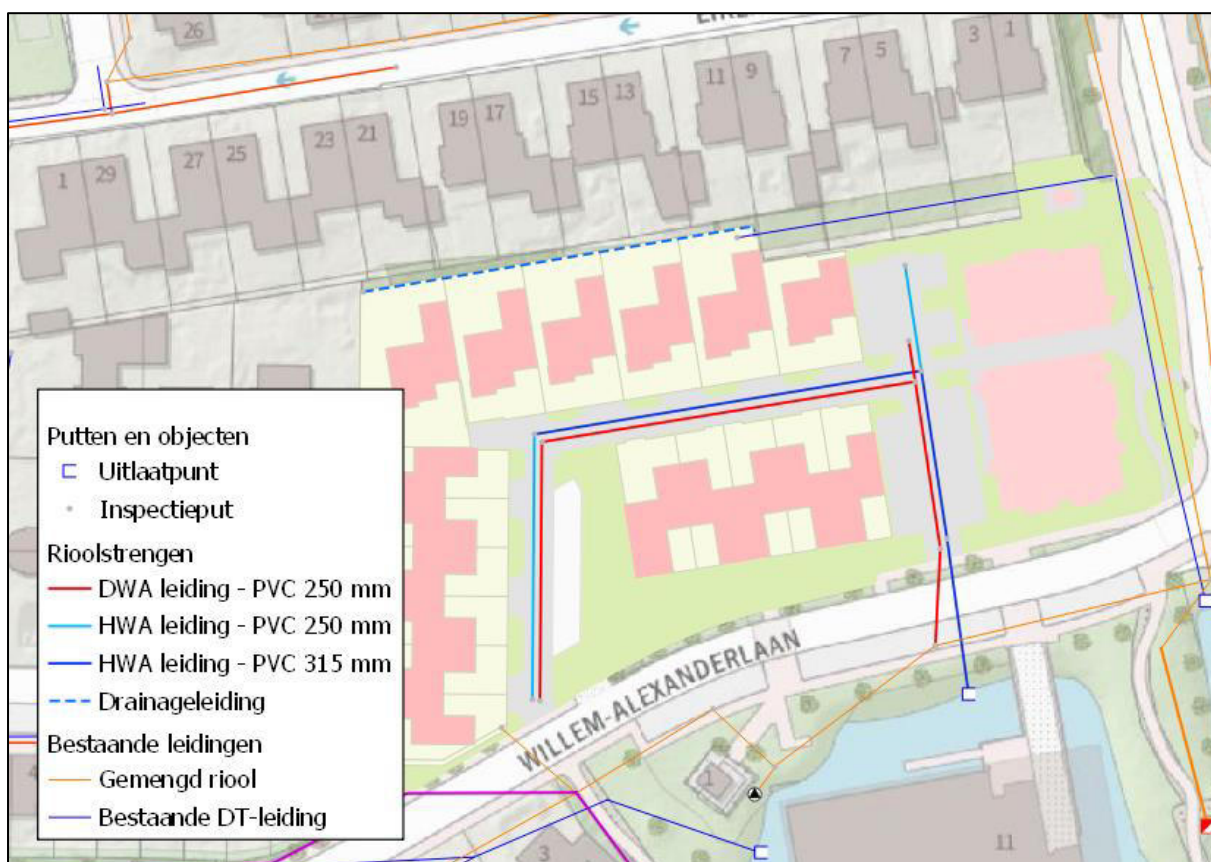
Afbeelding 3-1: Rioolontwerp met bestaande riolering.
