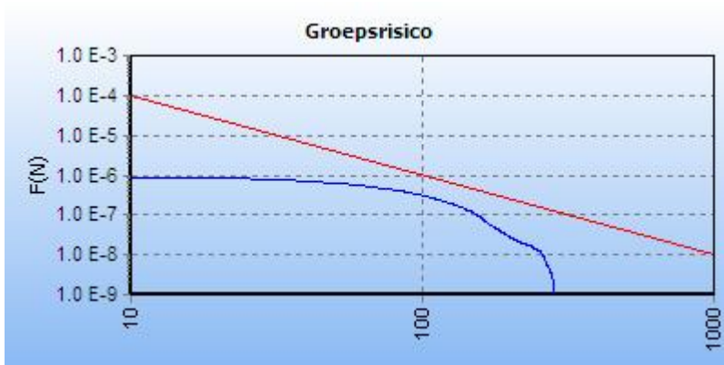
Figuur 5.1 FN curve voor W-514-16 van N.V. Nederlandse Gasunie voor de kilometer tussen stationing 7910.00 en stationing 8910.00
