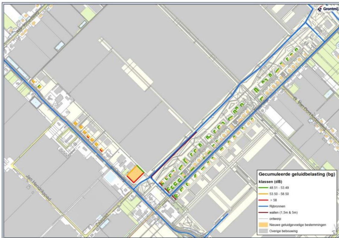
Figuur 4.2 Gecumuleerde geluidbelasting
