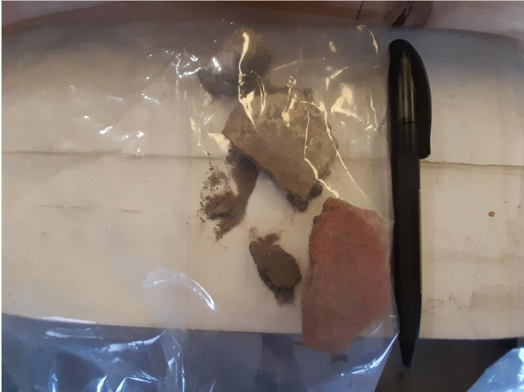
Foto 11: Asbestverdacht materiaal van terrein inspectie 30 juni 2020
