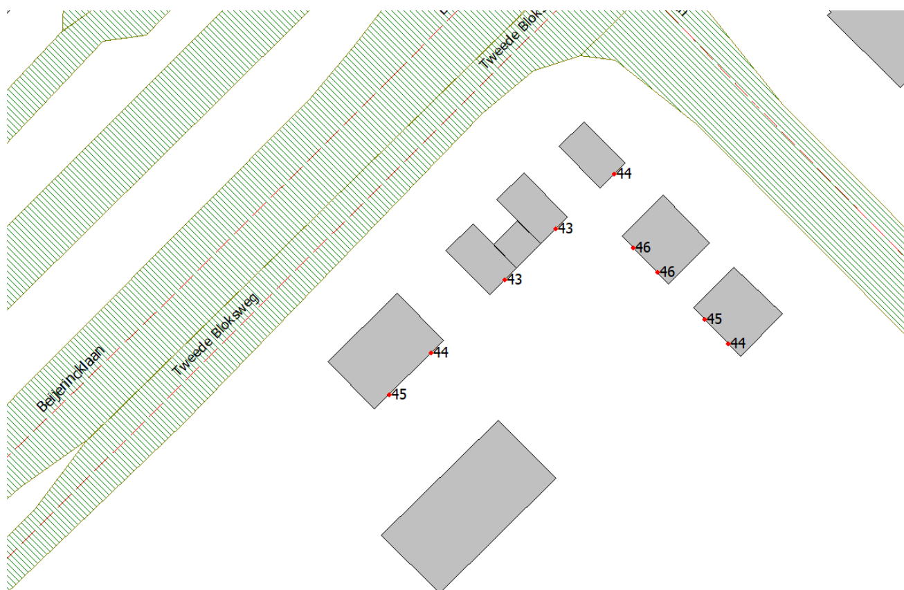
Figuur 5-1 geluidbelasting a.g.v. alle zoneplichtige wegen, rekenhoogte 1,5 meter (inclusief aftrek conform art. 110g Wgh)
