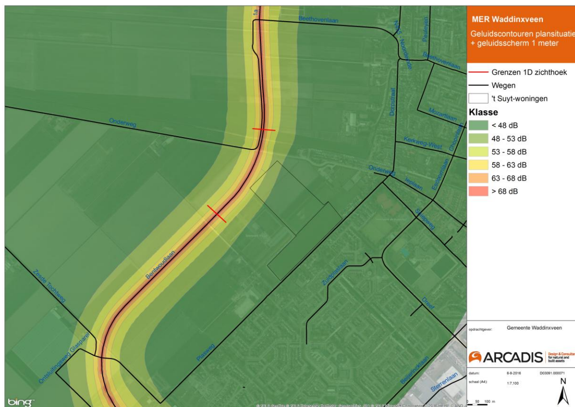
Figuur 5 Geluidscontouren in plansituatie met geluidsscherm van 1 meter hoog en 500 meter lang
