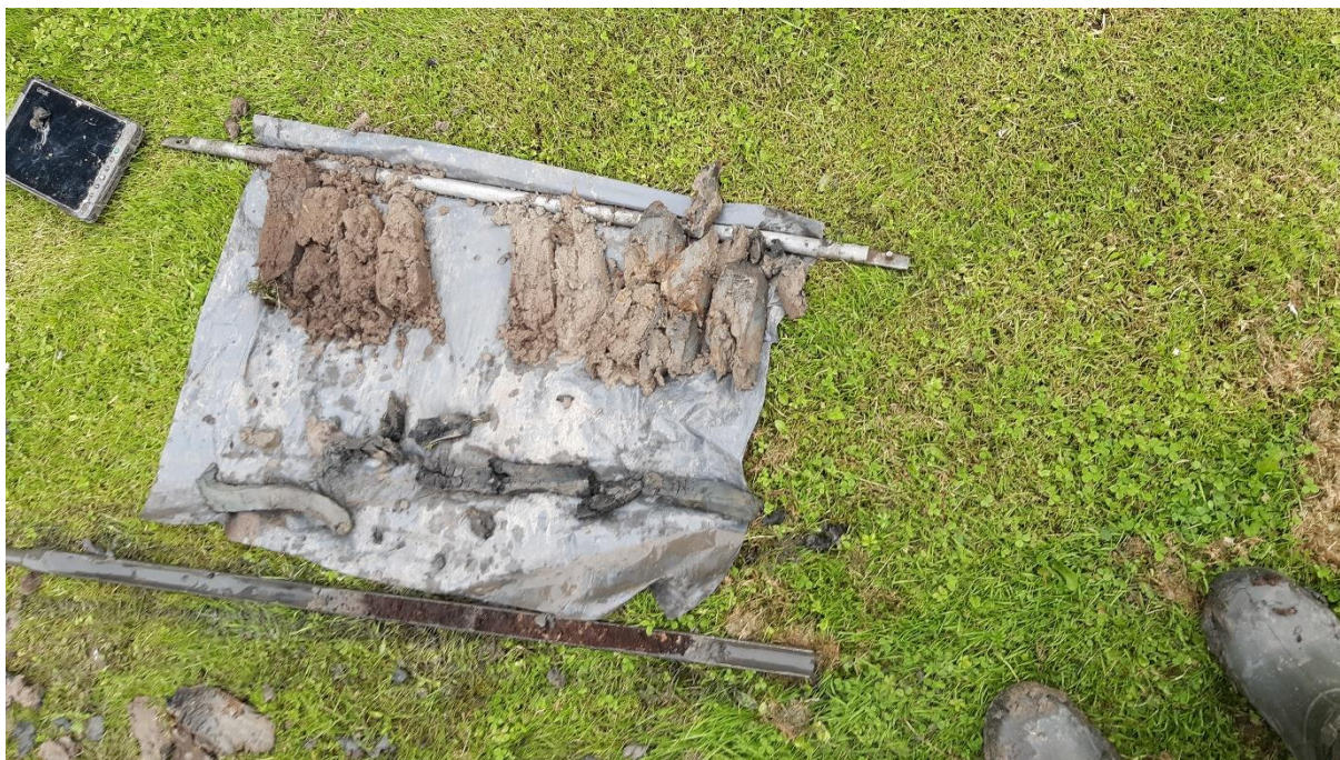
Afbeelding 6 De boorkernen van boring 4785009. Bron foto's: Vestigia dd. 29 juni 2021.
