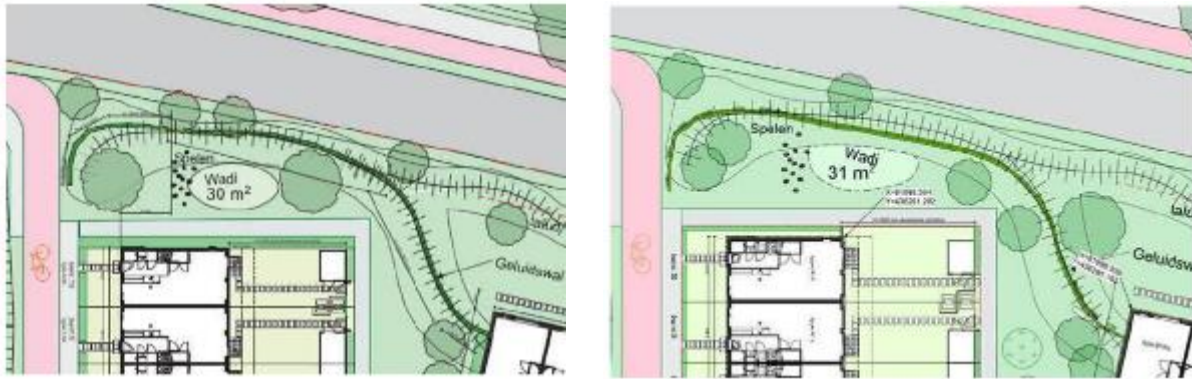
Figuur 4.1 Geluidsscherm voormalige situatie (links) en geluidsscherm nieuwe situatie (rechts)
