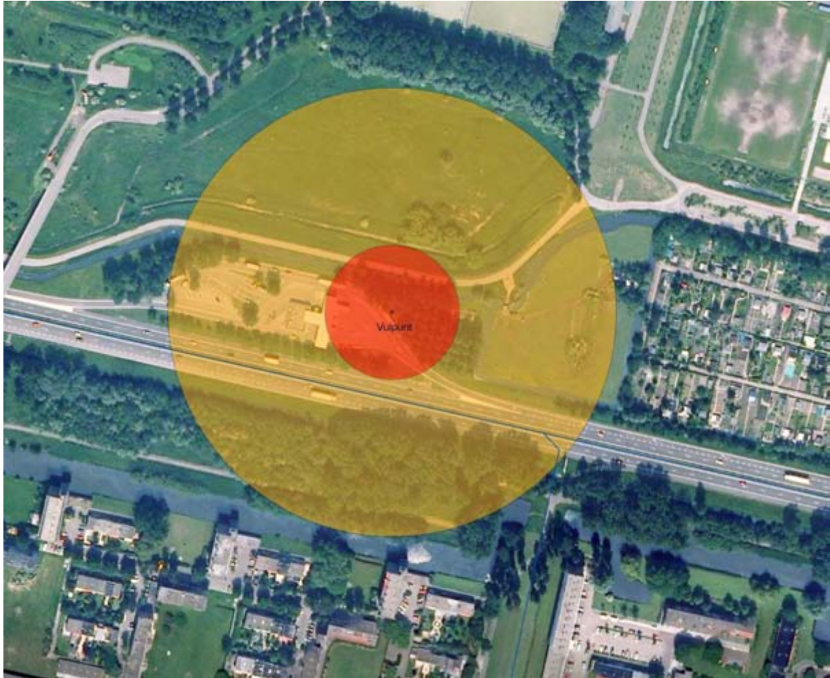
Figuur 32, overzicht contouren LPG tankstation BP, rijksweg A20
