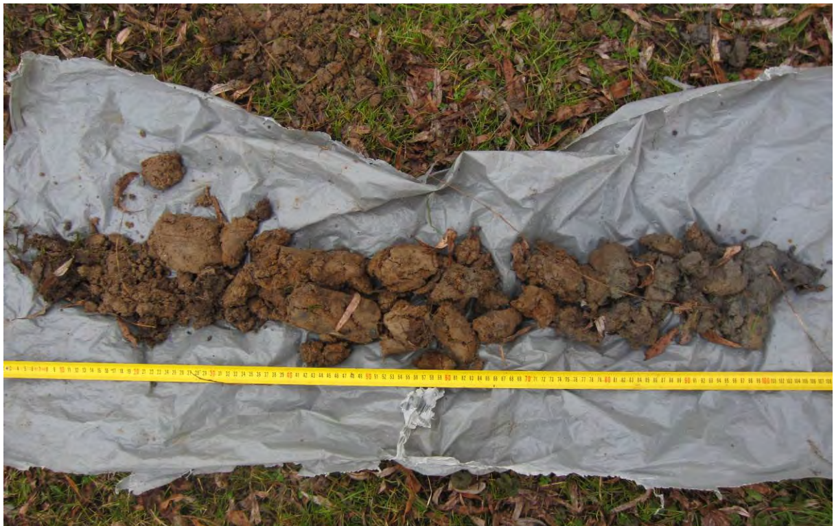
Bodemopbouw locatie 13 boring 2: Tot 75 cm zandige lichtbruine klei, daaronder zandig grijsbruine klei
