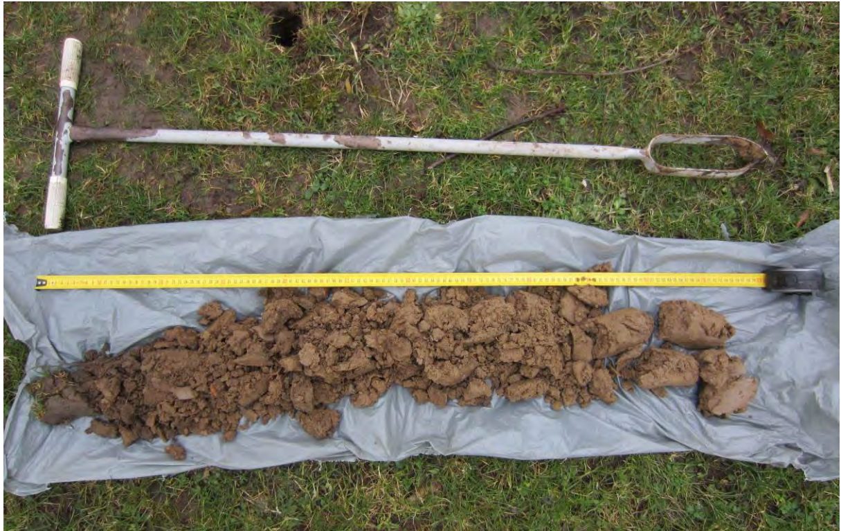
Bodemopbouw locatie 13 boring 1: Zandige lichtbruine klei
