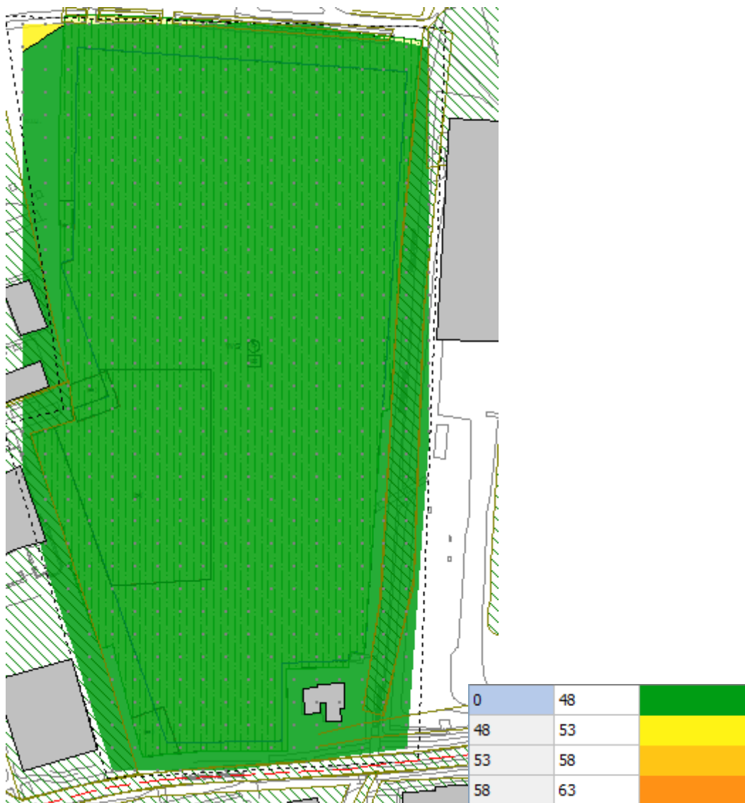
Figuur 4.3 Geluidscontouren ten gevolge van het verkeer op de Bentz-Berg op een hoogte van 10,5 m (inclusief aftrek)
