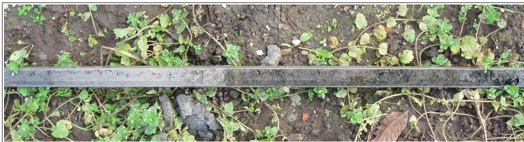
Figuur 4: Vianen, Blauwpoort: monster boring 16 van 275 (links) tot 190 (rechts) centimeter diepte. In het linker deel van de guts is natuurlijke zware klei zichtbaar. In het rechter deel bevindt zich de bovenliggende kleiige veenlaag. De veenlaag lijkt ontstaan door het dichtgroeien van bijvoorbeeld een sloot, gracht of dobbe.
