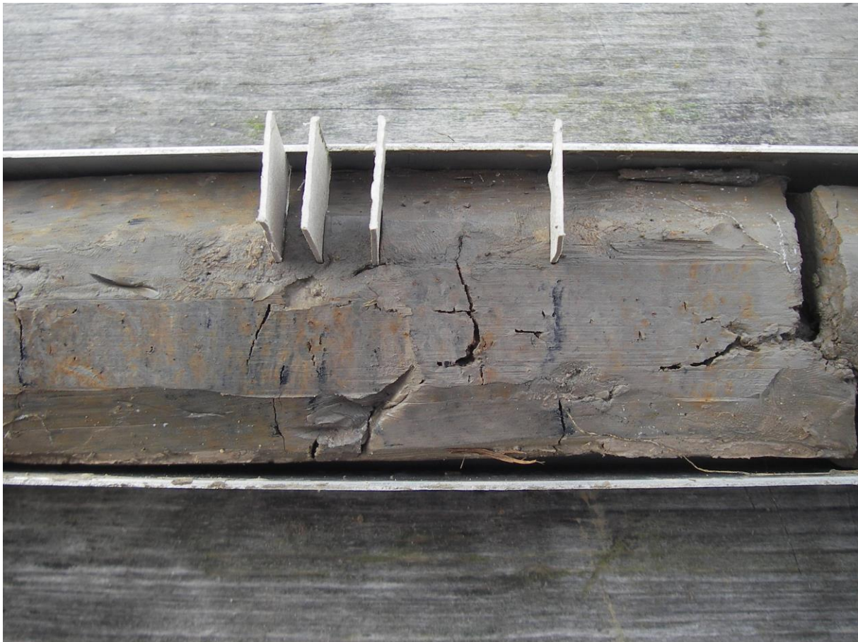
Figuur 5: Foto van het bemonsterde deel uit boring 89 met bij de kartonnen markeringen duidelijk te onderscheiden brandlaagjes. Naar boven toe (naar links op de foto) neemt de herkenbaarheid van de brandlaagjes af en neemt de mate van bioturbatie (de vlekkerigheid), toe.
