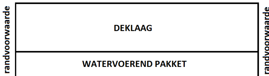
Figuur 3.6 Schematische weergave randvoorwaarde in model.
