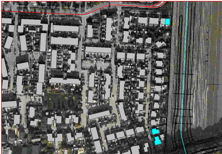
Figuur 4.1: Woningen waarvoor de voorkeursgrenswaarde wordt overschreden ten gevolge van de nieuwe weg
