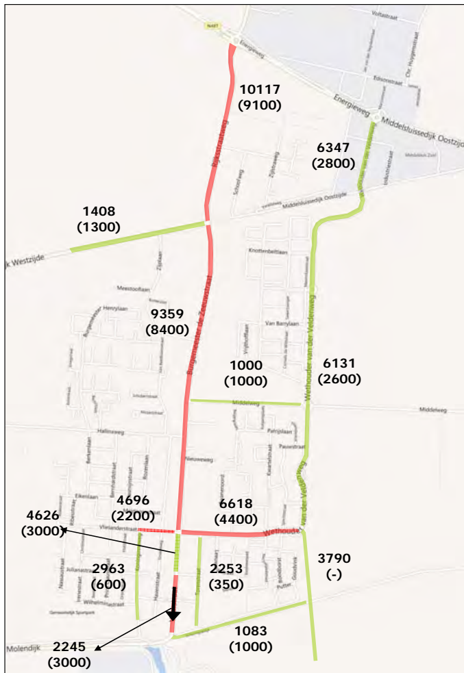
Figuur 4.2: Verkeersverdeling Lange termijn, eenrichtingsverkeer Voorstraat
