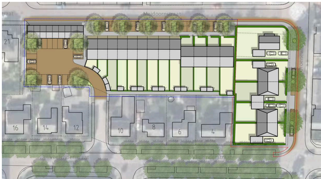
Figuur 2 De beoogde inrichting van de locatie. De ontwikkeling bestaat uit 13 rijtjes woningen, 1 vrijstaande woning, 4 twee-onder-een-kapwoningen en 9 garageboxen (verkavelingsplan door bosch-stabbers d.d. 22-10-2015).
