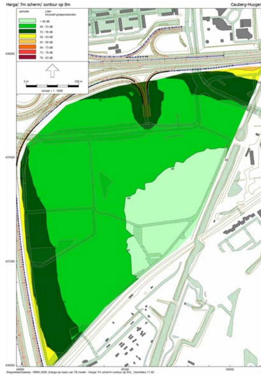
A4 en A20 gecumuleerd schermhoogte 7m contour 8m.
