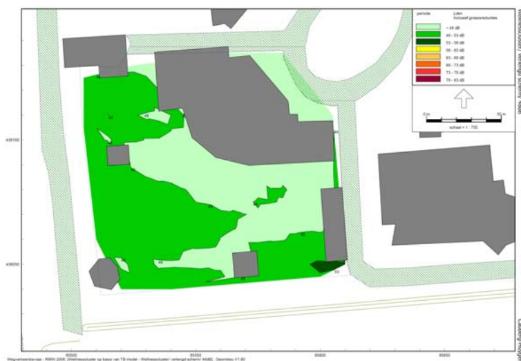
Geluidbelastingen Wellnesscluster schermhoogte 7m lengte 480m + 50 m scherm tussen toe- en afrit.
