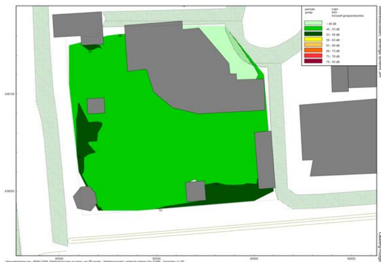
Geluidbelastingen Wellnesscluster schermhoogte 3m lengte 400m.
