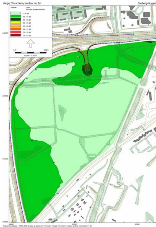
A4 en A20 gecumuleerd schermhoogte 7m contour 2m.
