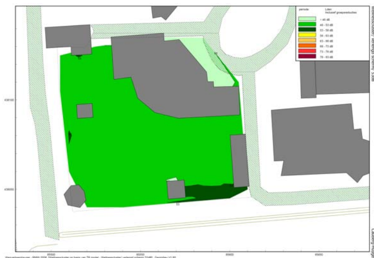
Geluidbelastingen Wellnesscluster schermhoogte 4m lengte 400m.
