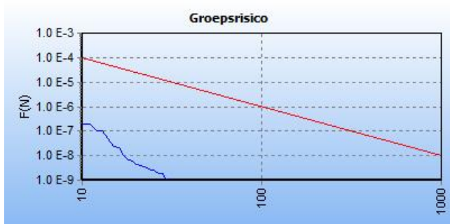
Figuur 25: De fN-curve voor deze kilometer leiding (leiding W-514-10 inclusief de verlegging).
