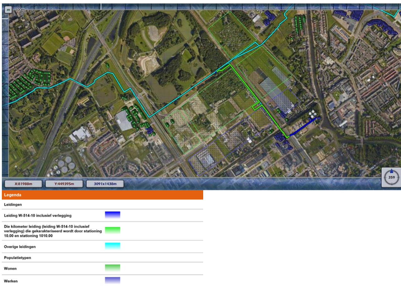
Figuur 24: Die kilometer leiding (leiding W-514-10 inclusief de verlegging) die gekarakteriseerd wordt door stationing 10.00 en stationing 1010.00.
