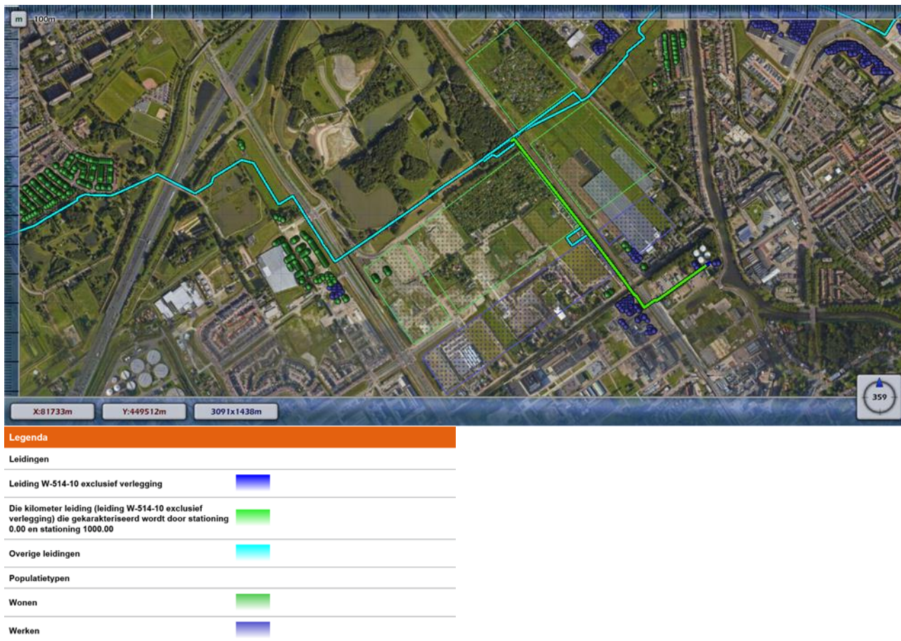
Figuur 21: Die kilometer leiding (leiding W-514-10 exclusief de verlegging) die gekarakteriseerd wordt door stationing 0.00 en stationing 1000.00.
