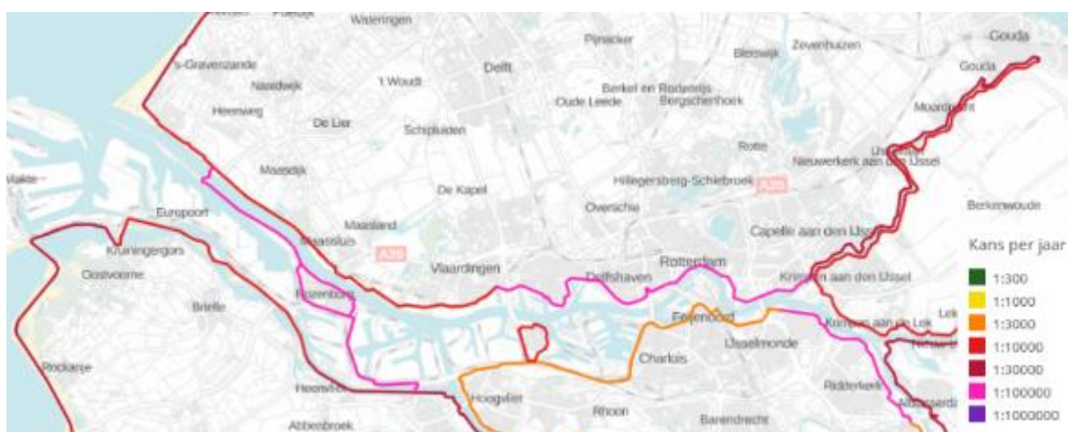
Figuur 3-1 Normspecificaties voor primaire waterkeringen, uitgedrukt in een overstromingskans per dijktraject [3]
