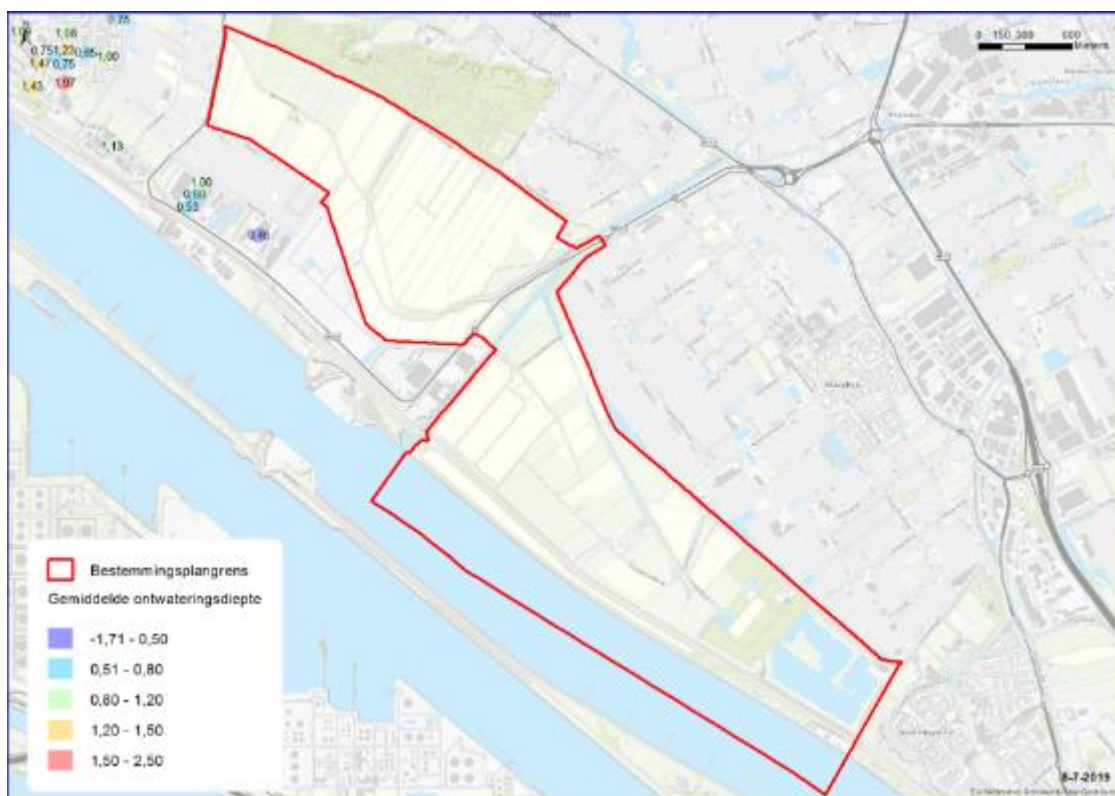
Figuur 4-3 Locatie peilbuizen en gemiddelde ontwateringsdiepte
