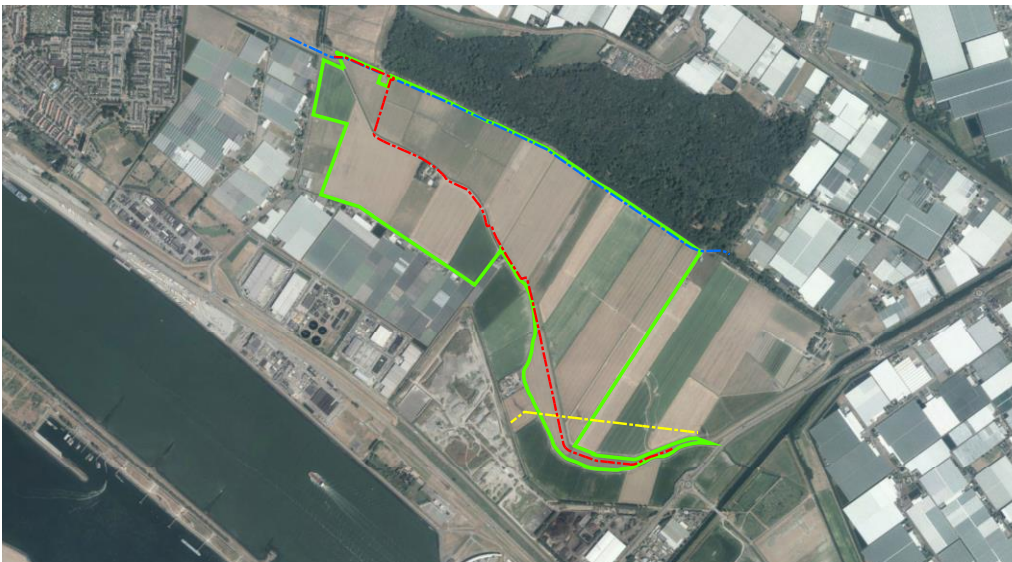
figuur 2.10: ligging kabels en leidingen binnen het plangebied (binnen de groene lijnen). Rode lijn: "buis met gevaarlijke inhoud" van de NAM; blauwe lijn: rioolpersleiding van Delfland; gele lijn: hoogspanningskabels van TenneT/Liander
