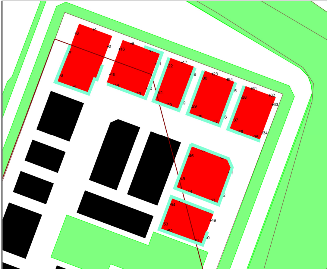
Figuur 5.2: Overzicht geluidluwe gevel(delen) en rekenpunten.
