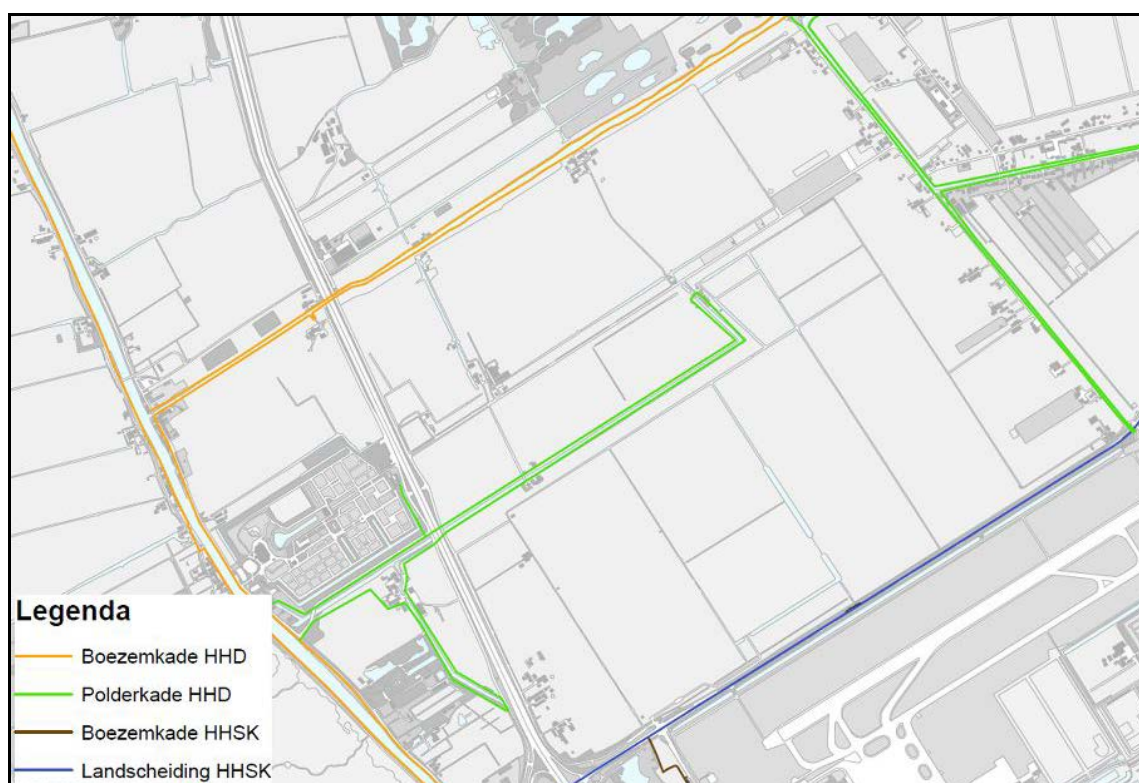
Afbeelding 4: Aanwezige waterkeringen in en rondom polder Schieveen.
