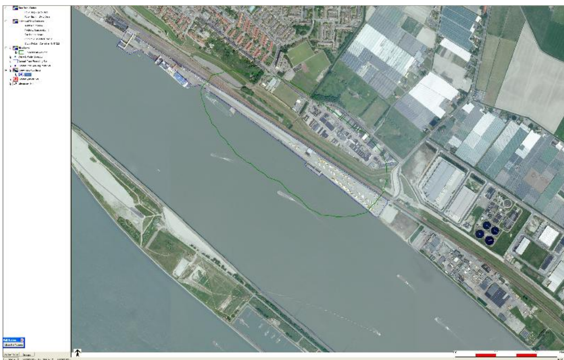
Figuur 5-4 Plaatsgebonden risicocontouren voor op- en overslag op het terrein van StenaLine (groene contour: PR 10^{-8} /jr)
