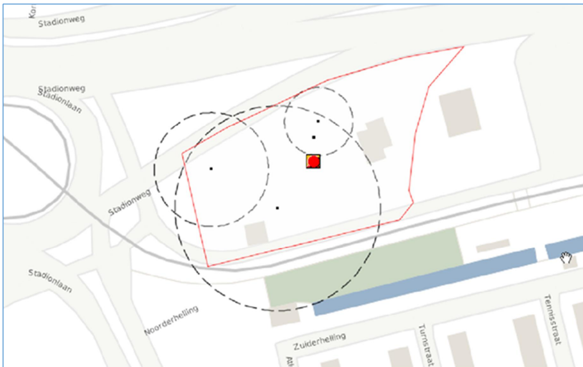
Figuur 3.1: plaatsgebonden 10 -6 risicocontouren van vulpistolen, ondergrondse tank en vulpunt. De inrichtingsgrens is rood omkaderd.
