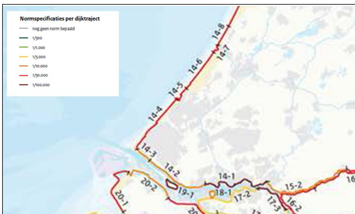
Figuur 3.1 Concept normspecificaties voor primaire waterkeringen, uitgedrukt in een overstromingskans per dijktraject [MvIM 2014]
