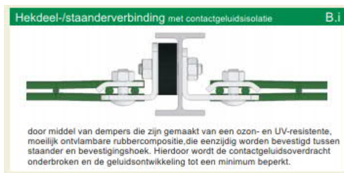
Afbeelding 3 Principedetail bevestiging van firma Legi B.i 1
