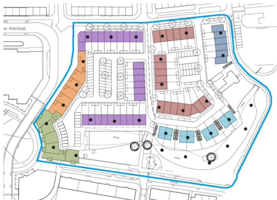
Figuur 1 kaart uit het Programma van Eisen met daarop de geplande boringen gerelateerd aan de geplande ingrepen. Met de kleuren worden de verschillende huizenblokken aangeduid, de zwarte stipjes duiden de geplande boorpunten aan. (bron: Moree 2013)
