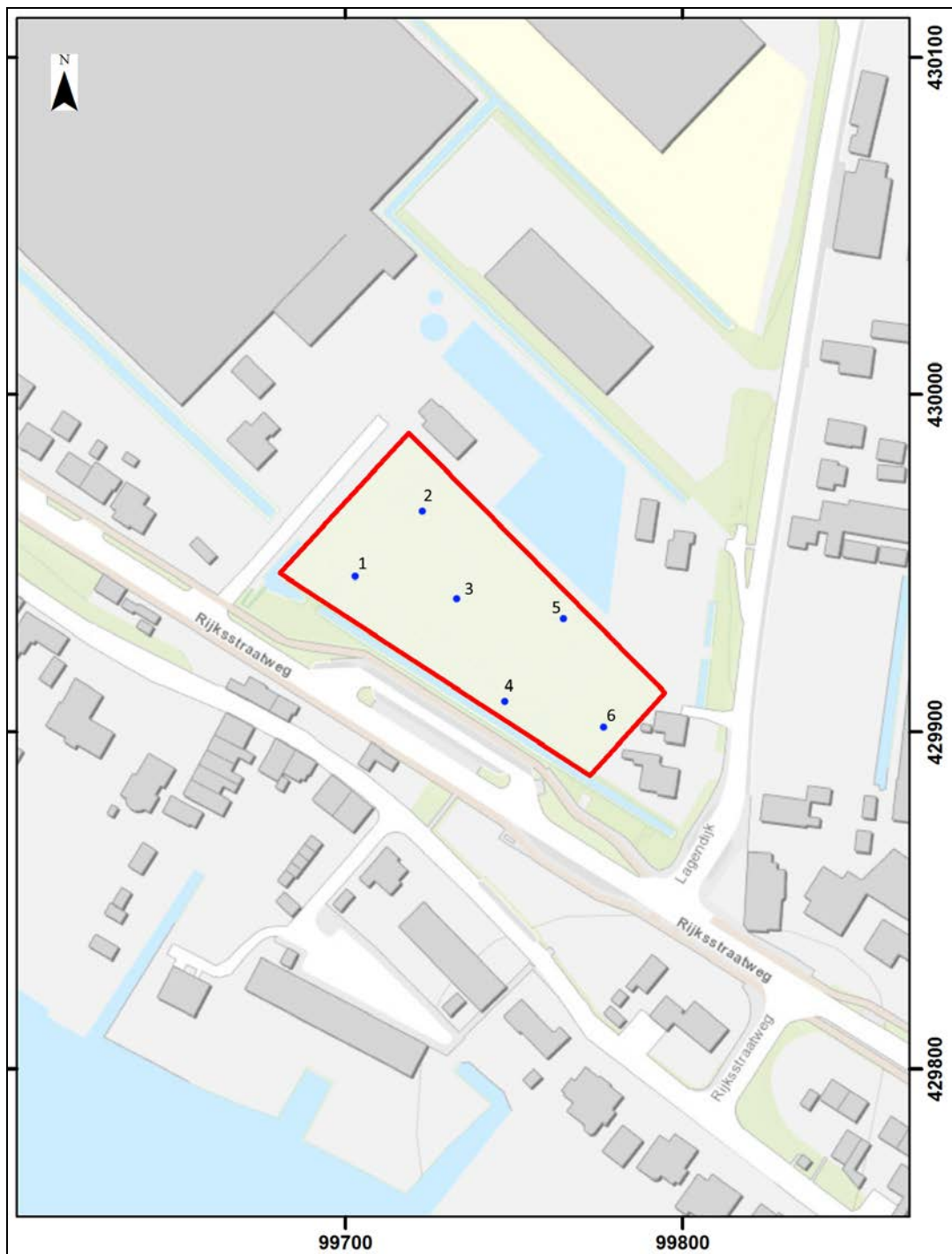
Afbeelding 17. Het plangebied (rood omkaderd) en de locaties van de boringen (blauw gemarkeerd), geprojecteerd op een uitsnede van de GBKN. Bron GBKN: Topografische Dienst Kadaster, Emmen [2012]. Schaal 1: 2.000.
