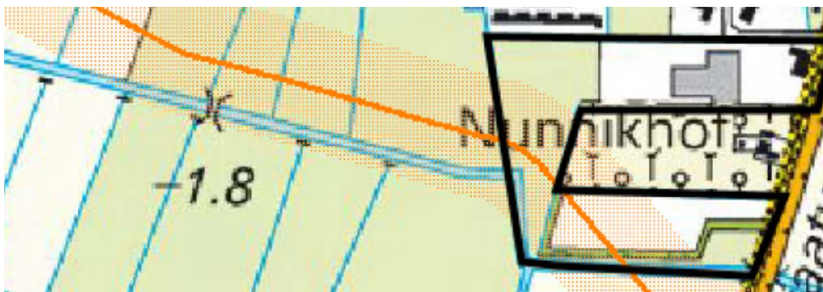
Afbeelding 1: Ligging buisleiding met gevaarlijke inhoud (oranje lijn) met rondom aandachtsgebied voor graafwerk
