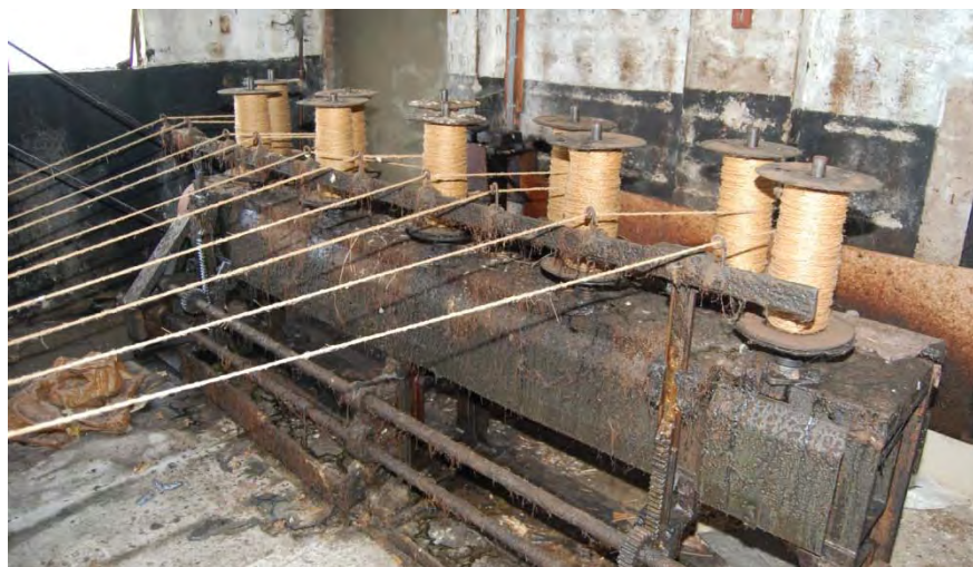
Overzichten van de teermachine in gebouw M (1925).
