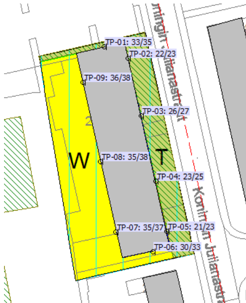
Figuur 4.3 Geluidbelasting op het plangebied als gevolg van het verkeer op de Molendijk, inclusief 5 dB aftrek
